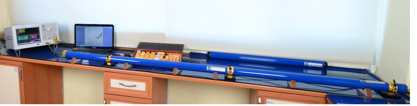
Resim 5: Koaksiyel Kablo Ekranlama Etkinliği Ölçüm Düzenegi
