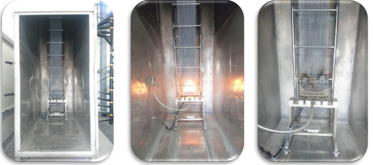
Resim 2: Test Edilen Numunenin Merdiven Üzerindeki Görünümü (EN 50399)
